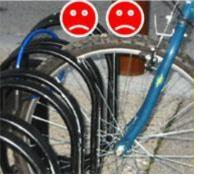
Seule la roue est attachée. Antivol de type câble léger : résiste 5 à 30 secondes à un outil compact, discret et peu coûteux.
